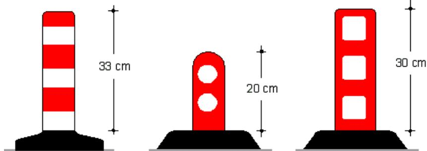
Gli elementi prefabbricati per salvagenti pedonali e delimitatori di corsia possono essere realizzati in calcestruzzo, costituiti da sezioni componibili mediante appositi incastri. Essi devono essere impiegati solo nelle zone urbane per la creazione di isole pedonali di rifugio ovvero piattaforme di carico.
