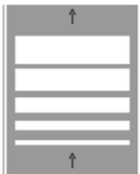
Sulla base delle indicazioni progettuali ovvero della Direzione Lavori, i sistemi di rallentamento ad **effetto acustico** saranno realizzati mediante irruvidimento della pavimentazione stradale ottenuta con la scarificazione o incisione superficiale della stessa o con l'applicazione di strati sottili di materiale in rilievo in aderenza, eventualmente integrato con dispositivi rifrangenti. Tali dispositivi possono anche determinare effetti vibratorii di limitata intensità.
