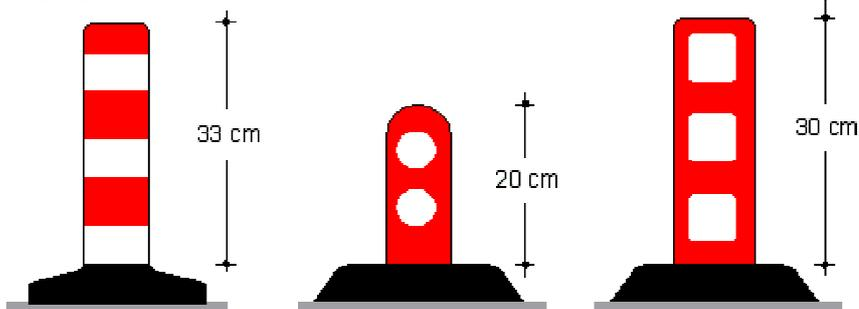
Gli elementi prefabbricati per salvagenti pedonali e delineatori di corsia possono essere realizzati in calcestruzzo, costituiti da sezioni componibili mediante appositi incastrati. Essi devono essere impiegati solo nelle zone urbane per la creazione di isole pedonali di rifugio ovvero piattaforme di carico.
