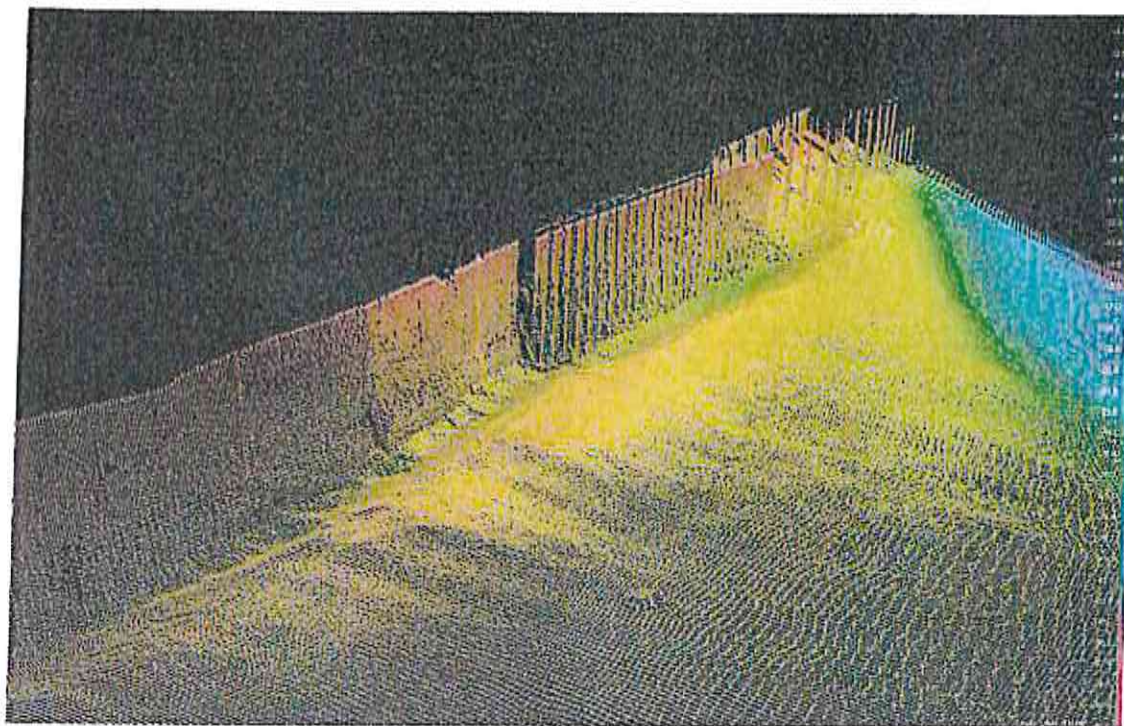
Estratto 3D del rilievo batimetrico (Zona 2)
